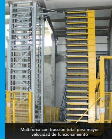
Multiforca con tracción total para mayor velocidad de funcionamiento
