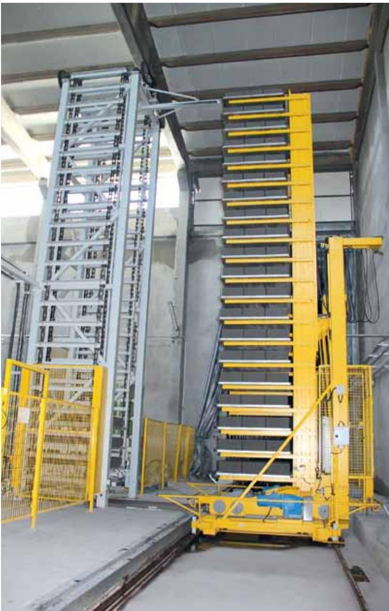
Para el transporte de bandejas a los secaderos, la instalación Megabloc puede ofertarse con un carro multiforca adaptado a las características de cada proyecto en cuanto a número de alturas, carga máxima de transporte, posibilidad de ir montado sobre plataforma giratoria, etc.
