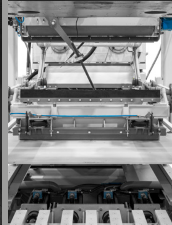
Elevación del marco del cajón en su marcha atrás para fabricar losas de gran tamaño.
